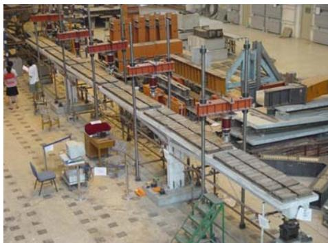
图 2 模型桥照片
