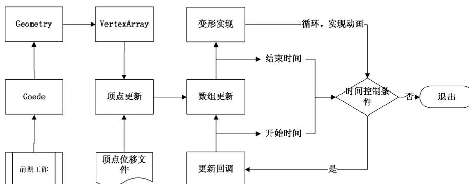
图 5 桥梁垮塌动画实现流程
