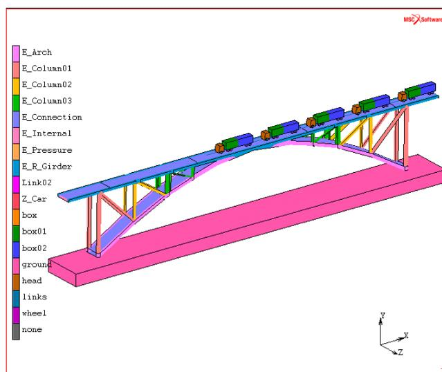
图 3 MSC.Marc 中的桥梁有限元模型
