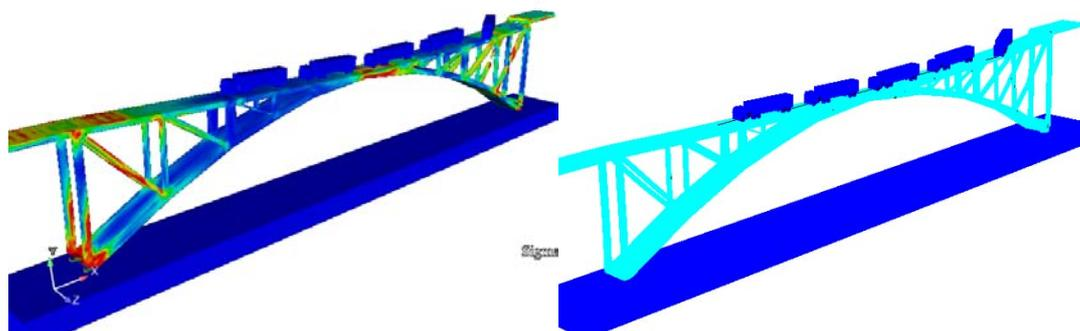
图 7 MSC. Marc 模拟结果和 OSG 桥梁垮塌动画 (7. 8s)
