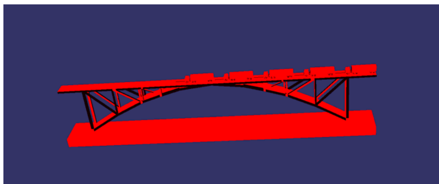
图 4 基于 MSC.Marc 数据的 OSG 桥梁场景模型
