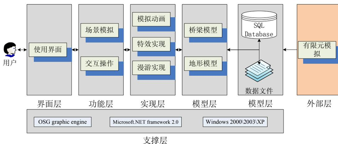
图 1 桥梁垮塌场景模拟系统架构图
