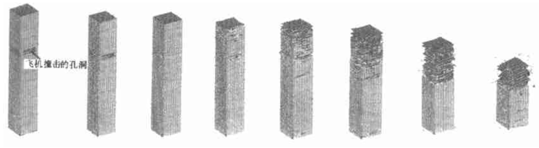
图 1 北塔倒塌过程——透视图
