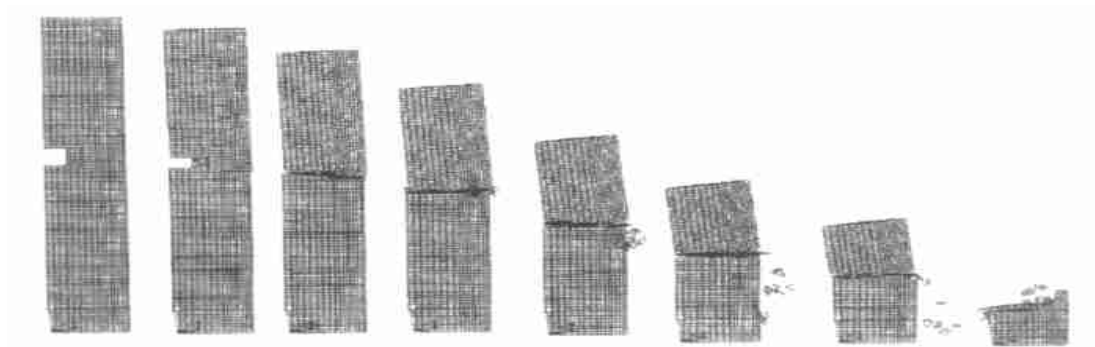
图 4 南塔倒塌过程——侧视图
